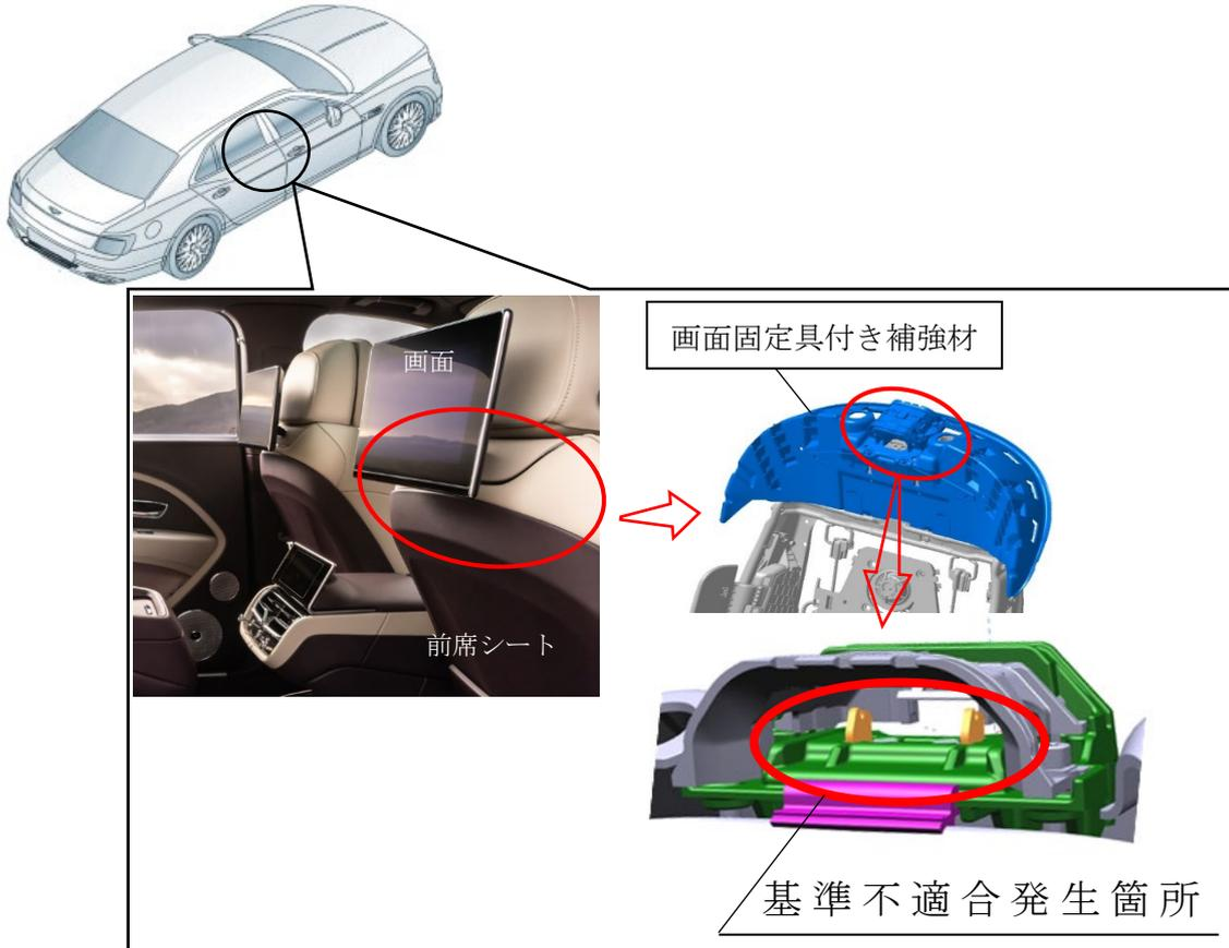
後席乗員用マルチメディアシステムの脱着式画面を装着する固定具において、組立指示が不適切なため、固定具が間違っ組立てられている、または一部の部品が取付けられていないものがある。そのため、当該画面を装着した時に固定が不十分となり、車両衝突時に画面が外れ、乗員が負傷するおそれがある。
